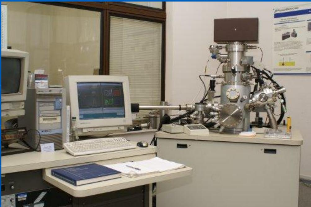
*Исследование элементного состава твердофазных материалов методом электронной Оже-спектроскопии (ЭОС) основано на анализе энергетического распределения Оже-электронов, эмитированных с поверхности вещества в вакууме при его возбуждении электронным пучком.*
