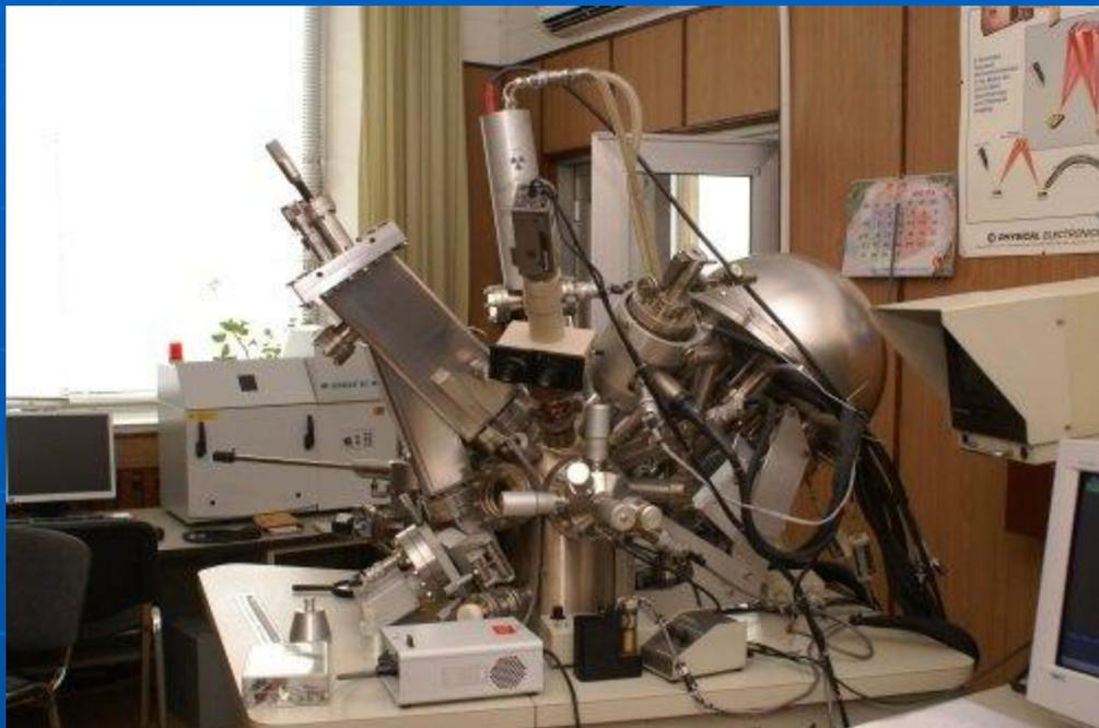
*Исследование химического состава твердофазных материалов методом рентгеновской фотоэлектронной спектроскопии (РФЭС) основано на анализе энергетического распределения фотоэлектронов, эмитированных с поверхности вещества в вакууме при его возбуждении рентгеновскими фотонами.*
