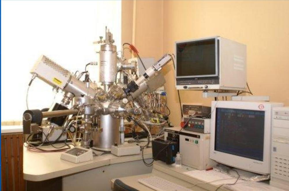
*Исследование элементного состава и распределения примесей по глубине основано на анализе эмиссии вторичных ионов, испущенных из мишени при ионной бомбардировке.*
