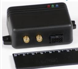
**Дополнительно в корпус можно вмонтировать резервный аккумулятор на 1100мА или отдельно 7000 мА (автономной работы 120 часов )**
