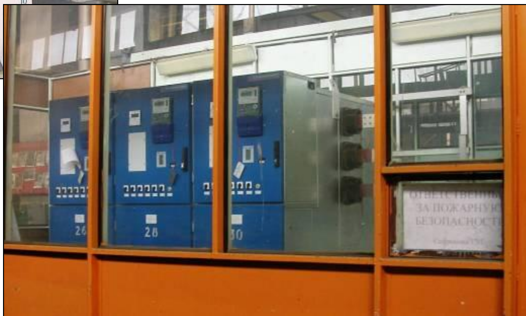
Шкафы серии К-129 в испытательном стенде
