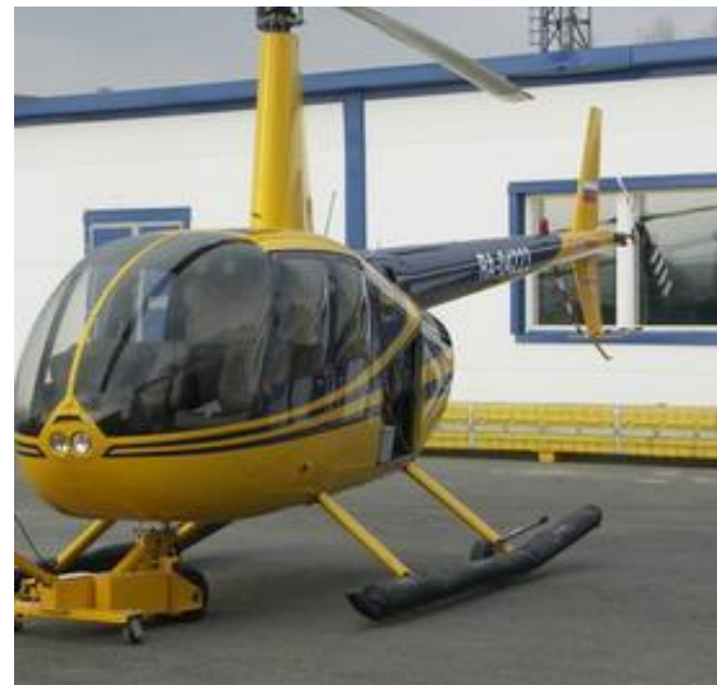
R-44 Clipper с «аварийными» поплавками
