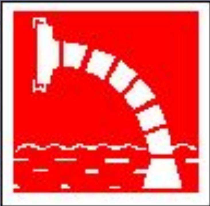
Используется для обозначения места нахождения пожарного водоема или пирса для пожарных машин
