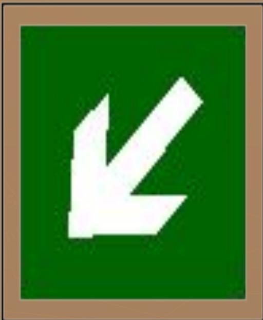
Используется на путях эвакуации совместно со знаком для обозначения направления к эвакуационному выходу
