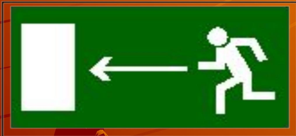
Используется на путях эвакуации для указания направления движения к эвакуационному выходу
