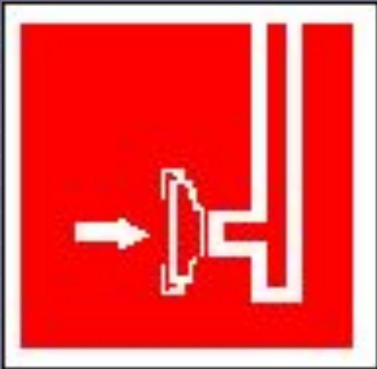
Используется для обозначения места нахождения пожарного сухотрубного стояка
