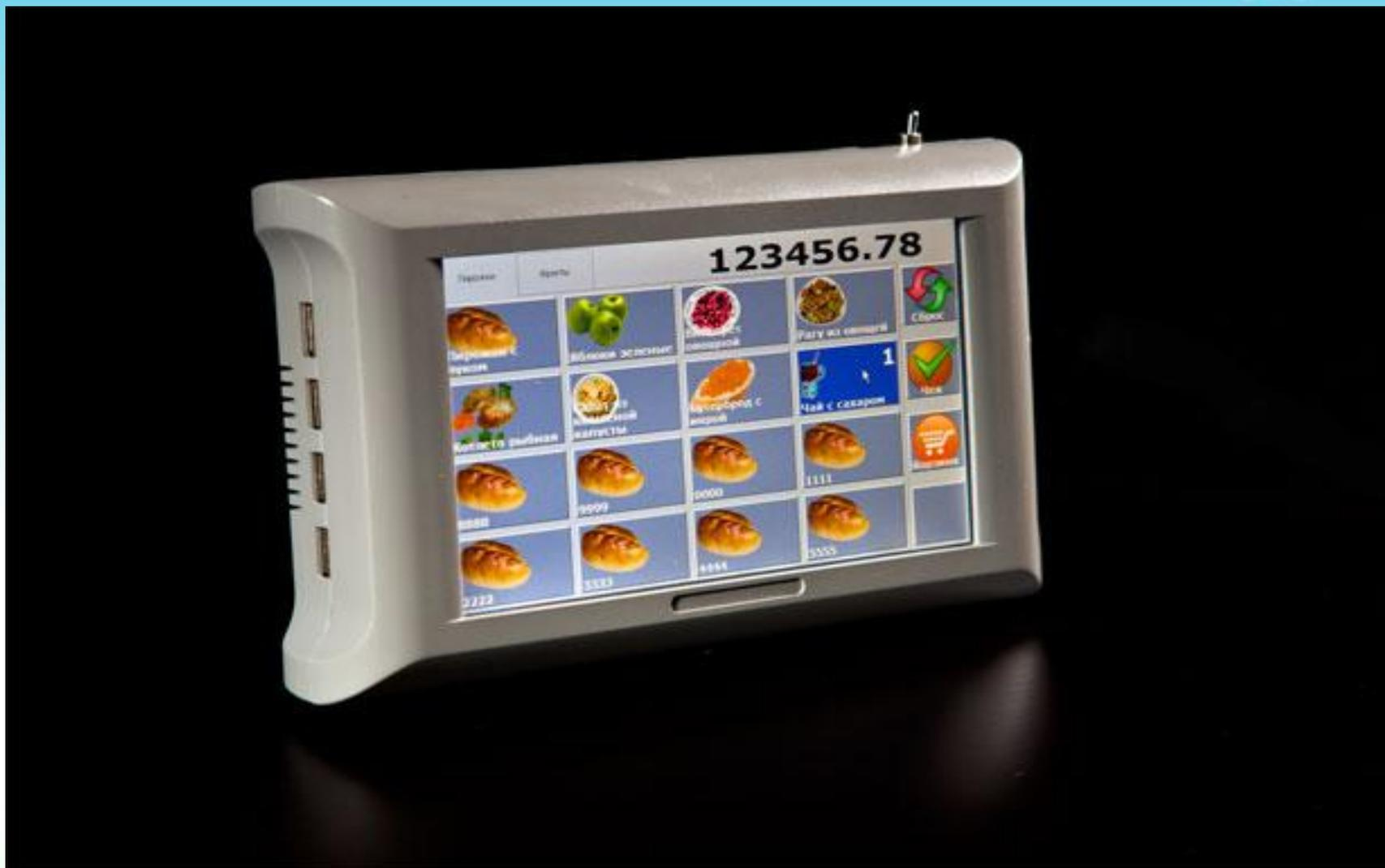
Полноценный компьютер небольшого размера. С обратной стороны имеет разъемы для подключения к стандартным кронштейнам VESA 75 или для того, чтобы просто повесить его на стену.
