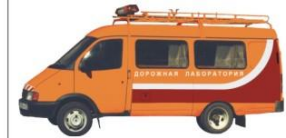
Передвижная дорожная лаборатория технического надзора КП-531
