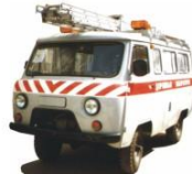
Передвижная дорожная лаборатория диагностики мостов КП-532
