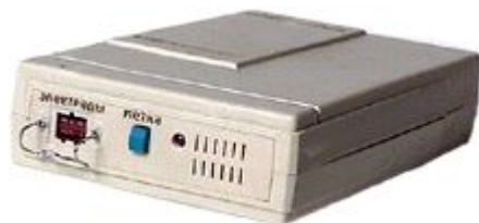
Носимый аппарат суточного мониторирования ЭКГ (Холтер)
