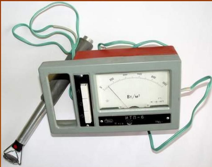
Измеритель теплового потока ИТП-6:
