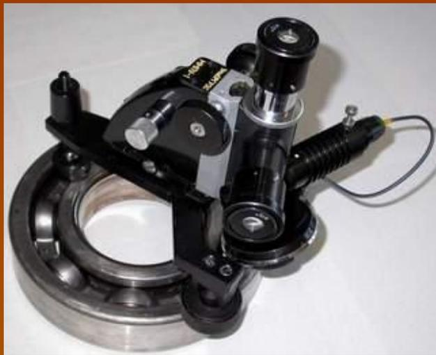
*Данный комплекс позволяет проводить анализ структуры металла непосредственно на технологическом оборудовании с использованием переносного металлографического микроскопа ММПУ-1. Изображение структуры с помощью цифрового фотоаппарата переносится в ПЭВМ с последующей программной обработкой результатов и выдачей отчета.*
