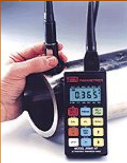
Толщиномер 26 MG - позволяет проводить исследования корродирующих материалов т.е. измерения проводятся практически без зачистки поверхности контроля.
