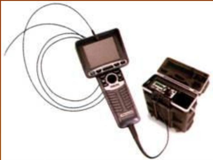
*Данный прибор может использоваться для внутреннего осмотра и дефектации (без разборки): коллекторов котлов, трубопроводов, паровых и газовых турбин, сосудов, реактивных двигателей и т.д.*
