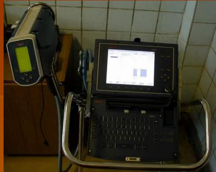
**Анализатор химического состава металлов *ARC-MET 8000*:**
