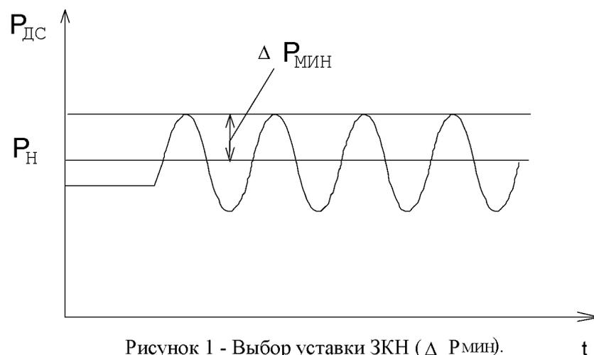
Рисунок 1 - Выбор уставки ЗКН ( $\Delta P_{\text{мин}}$ ).
