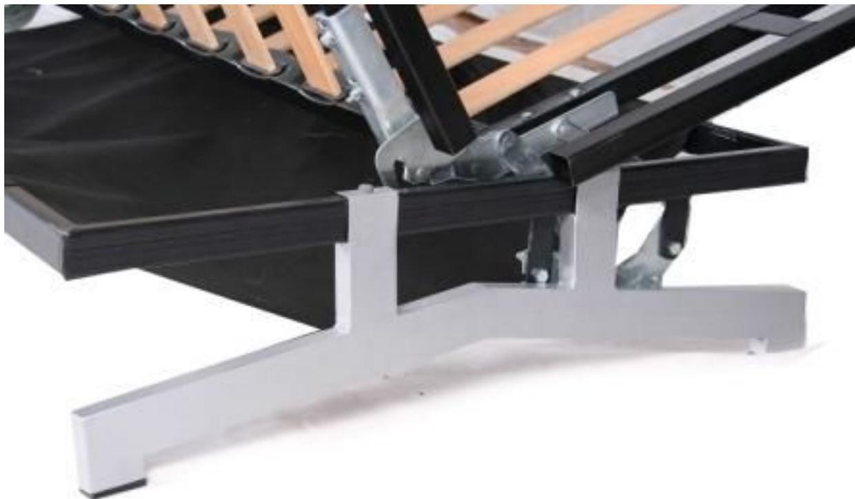
Опора высотой 180мм, полиамидная заглушка, материал опоры холоднокатаная электросварная профильная труба 50x25мм, толщина стенки 2 мм, окрашена порошковой краской, цвет алюм.
