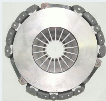
Нажимной диск сцепления (корзина) – вид снизу
