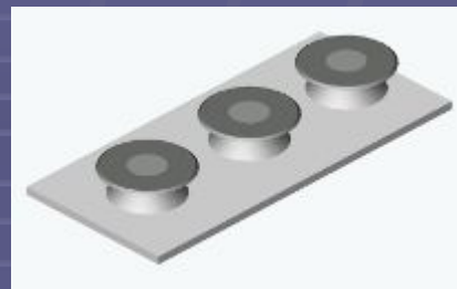
Кварцевые диски на ножках после травления \text{XeF}_2
