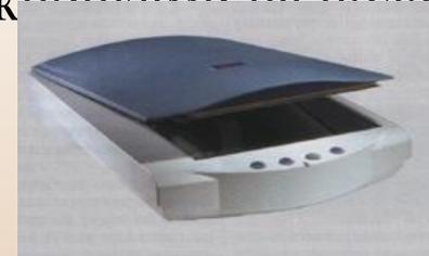
**Рис. 12 Планшетный сканер**
