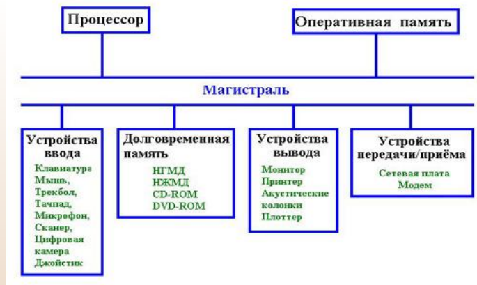
Рис. 5 Функциональная схема компьютера
