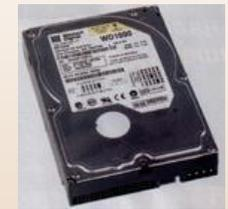
**Рис. 7б Жесткий диск (винчестер)**
