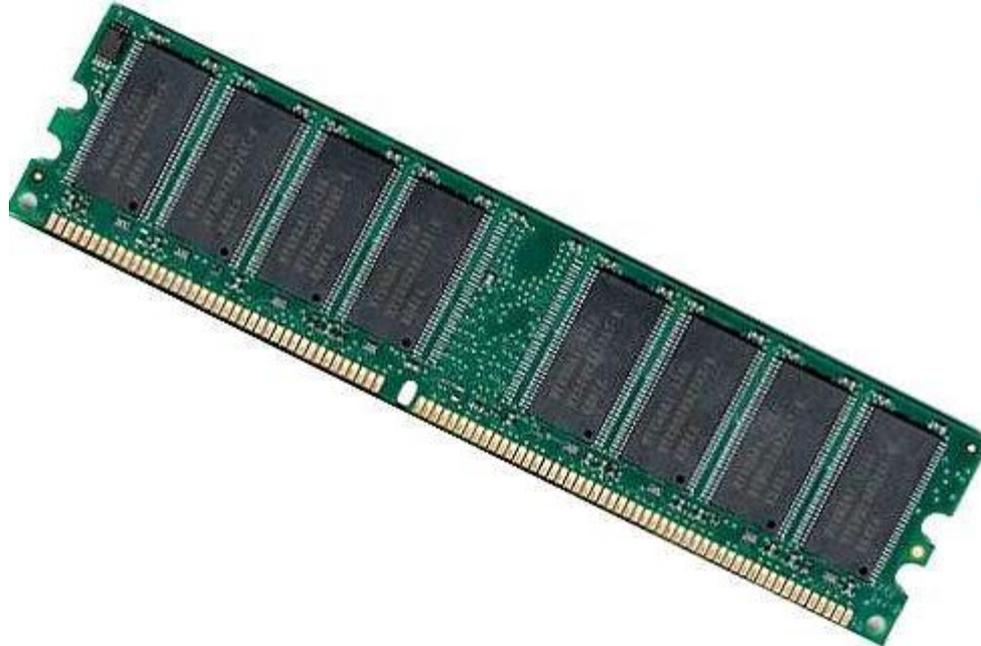
Модули памяти представляют собой пластины, на которых размещаются большие интегральные схемы (БИС) памяти. Модули могут различаться между собой по размеру, количеству контактов, быстродействию, по информационной емкости и т.д.
