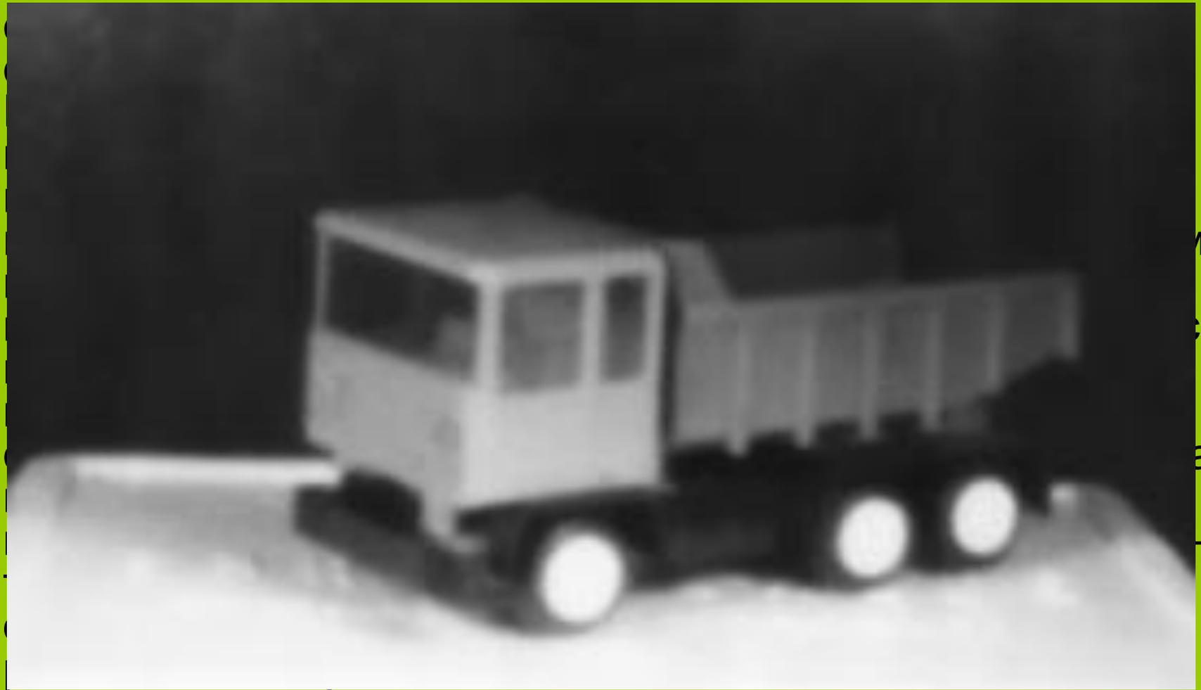
Фотография, сделанная при помощи зонной пластинки с одной открытой зоной Френеля.
