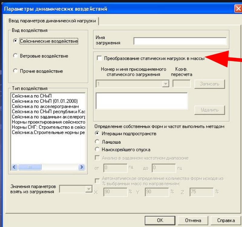
При построении динамических расчетных моделей большое значение имеет способ задания инерционных характеристик. Имеется возможность использовать для этой цели статические загрузки, которые уже содержали в себе данные о нагрузках от собственного веса сооружения и расположенного на нем оборудования, материалах и т.п.
