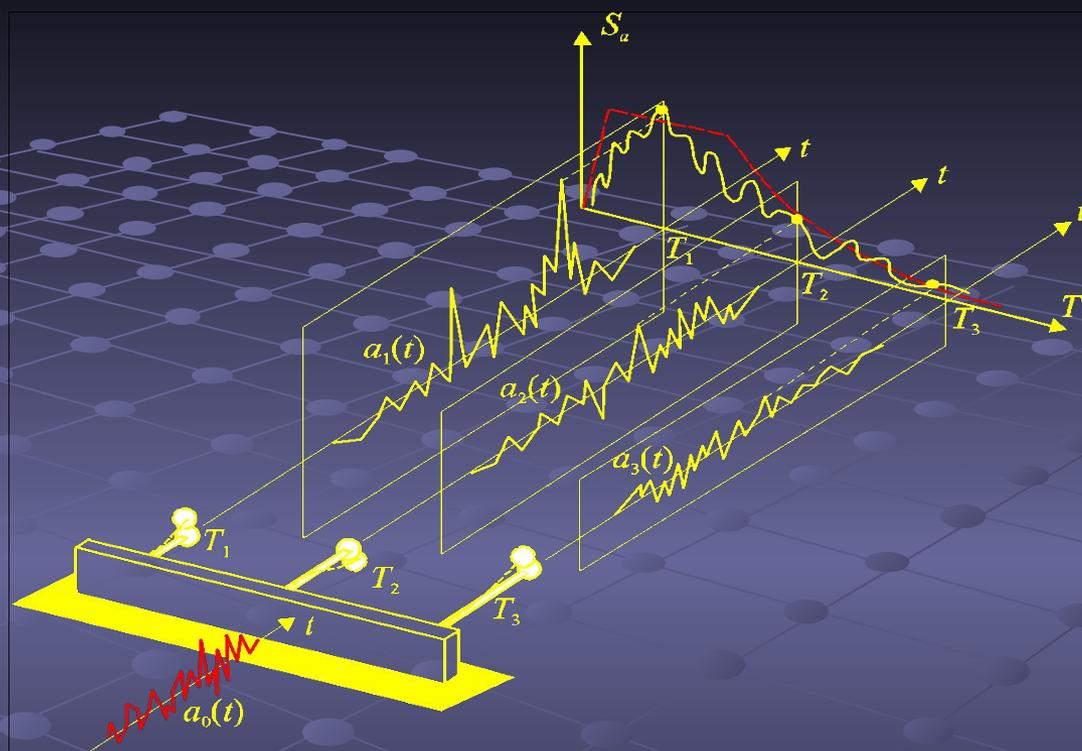
В основе линейно-спектральной теории лежит анализ реакции простых осцилляторов на сейсмическое воздействие, который представлен в форме огибающей экстремальных значений для каждого осциллятора.
