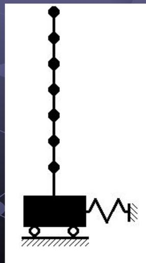
Для каждой учитываемой формы собственных колебаний коэффициент вклада равен работе сил инерции на перемещениях переносного движения системы. Если учесть все формы, то сумма коэффициентов вклада будет равна единице, при удержании части форм подсчитывается процент выбранных масс
