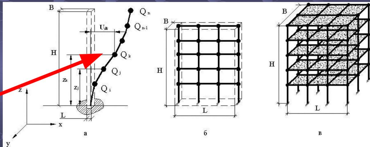
Машинные расчеты выполняются по пространственным схемам с сосредоточенными и распределенными массами (последние приводятся к узловым в рамках МКЭ) и проблема состоит в том, что многие положения норм все же тяготеют к консольной расчетной модели.
