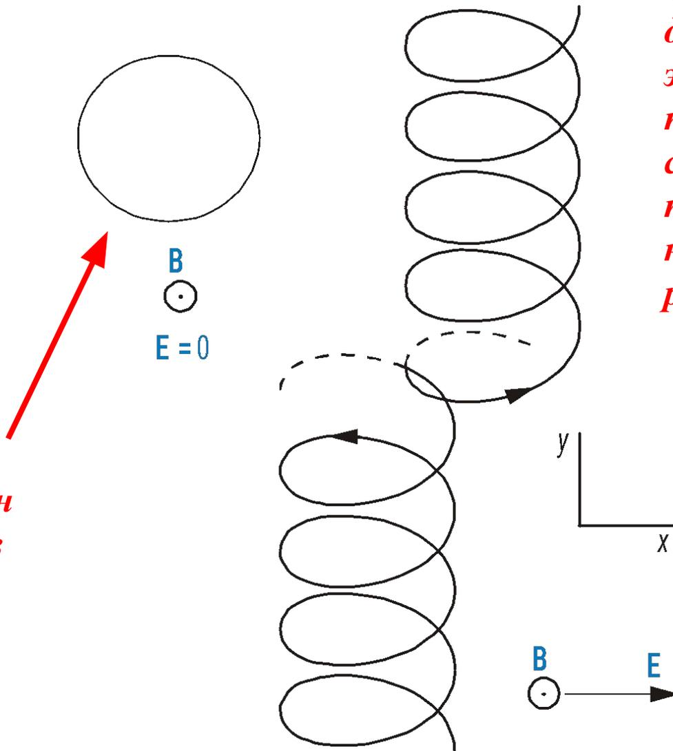
*Электрон дрейфует поперек электрического поля, а вдоль поля смещается только при наличии рассеяния*
