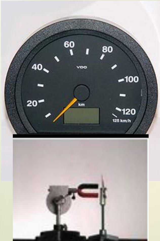
Действие спидометра основано на появлении электрического тока во вращающемся алюминиевом диске, над которым находится магнит. Диск приводится во вращение от гибкого вала, соединенного с колесами автомобиля
