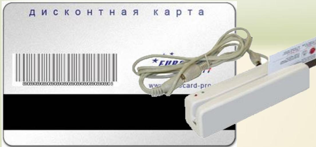
При введении карточки в автоматическое устройство магнитная полоска проходит мимо катушки датчика прибора.
