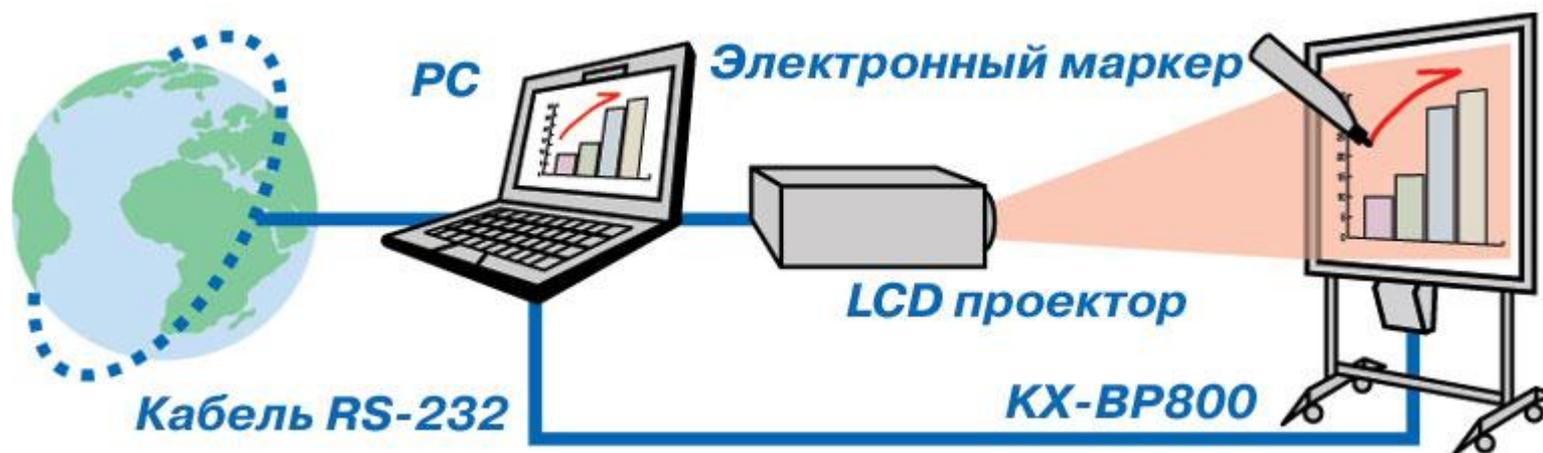
Для работы с электронной доской необходимы мультимедийный проектор и компьютер со специальным программным обеспечением
