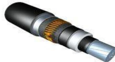
Силовые кабели с медными или алюминиевыми жилами, с изоляцией из сшитого полиэтилена в полиэтиленовой оболочке с продольной герметизацией.
