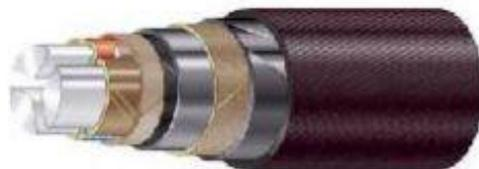
Кабели силовые с алюминиевыми жилами, с бумажной изоляцией, пропитанной вязким составом, с алюминиевой оболочкой, с защитными покровами, на напряжение 1,6 и 10 кВт.
