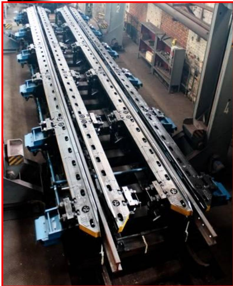
**Назначение:** для торможения и регулирования скорости вагонных отцепов на парковых тормозных позициях механизированных и автоматизированных сортировочных горок.
