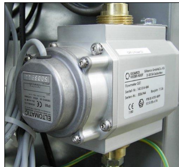
Объемомер GE1 с генератором импульсов Eltomatic (для мониторинга)
