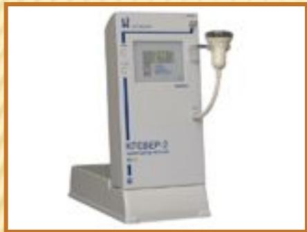
Анализатор молока **"Клевер-2"** обеспечивает экспресс-оценку процентного содержания жира, белка, сухого обезжиренного молочного остатка (СОМО) и плотности в одной пробе свежего цельного, консервированного молока или сливок.
