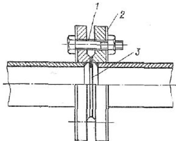
Рис. XII.9. Электроизолирующее фланцевое соединение трубопроводов:
