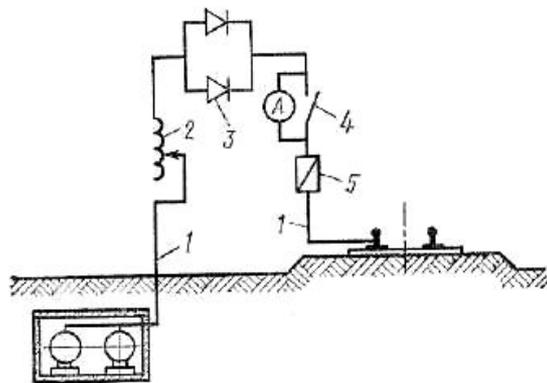
Рис. XII.7. Схема поляризованного электродренажа:
