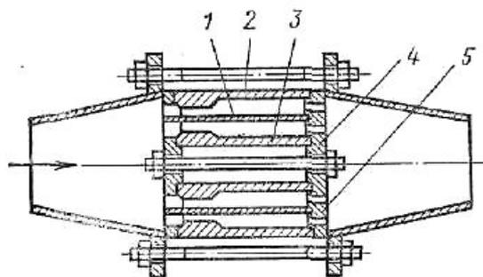
Рис. XII.12. Схема аппарата с постоянными магнитами для обработки воды:
