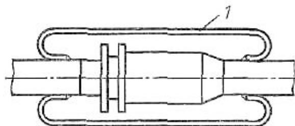
Рис. XII.10. Шунтирующая перемычка на сальниковом компенсаторе:
