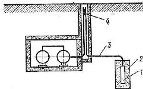
Рис. XII.8. Схема протекторной защиты трубопроводов:
