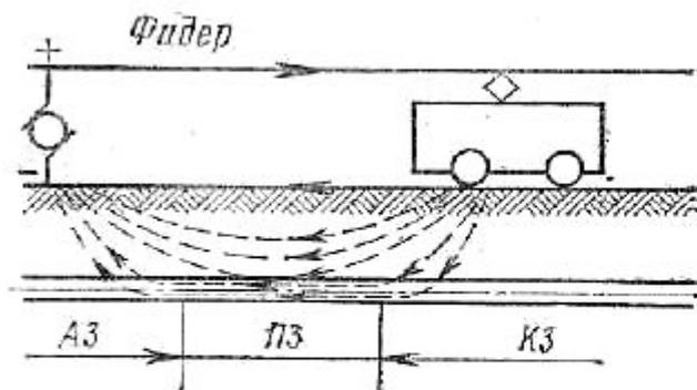
Рис. XII.5. Схема распространения блуждающих токов
