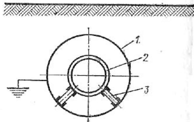
Рис. XII.6. Схема размещения трубопровода в металлическом футляре:
