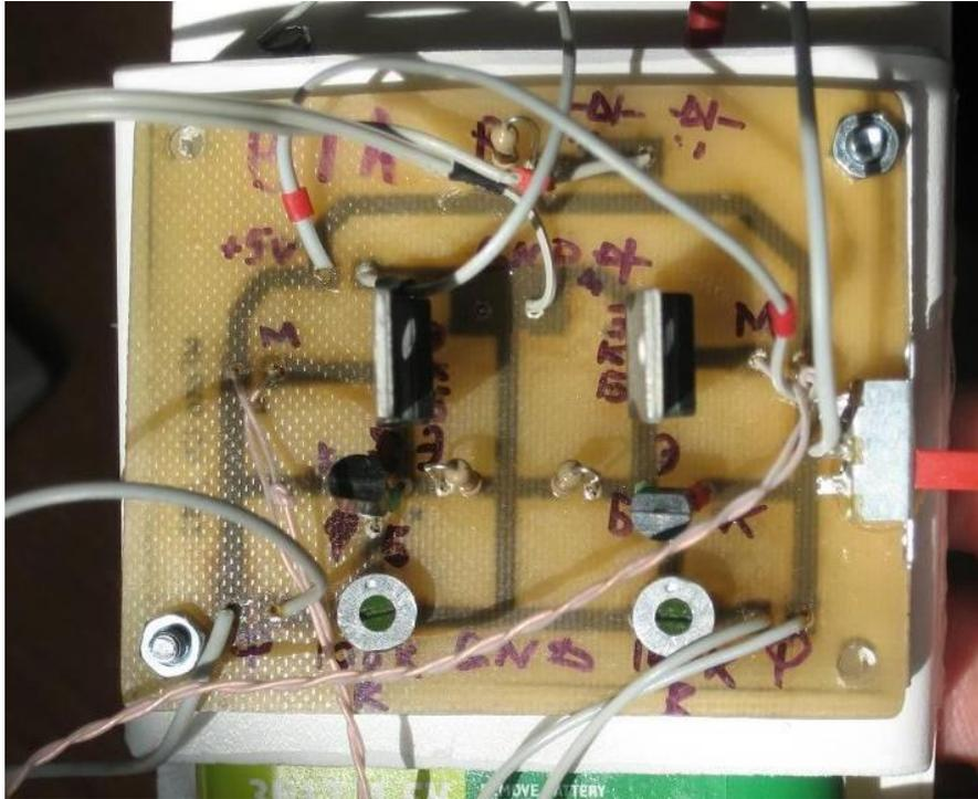
Плата с дискретными элементами
