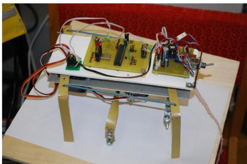
Исследовательский прототип шагающего робота
