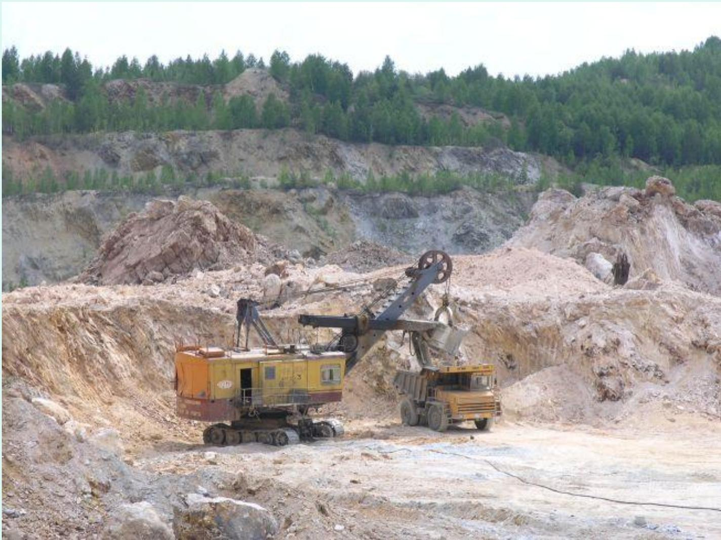
**Карьер – совокупность горных выработок ,образованных При добыче полезного ископаемого открытым способом.**
