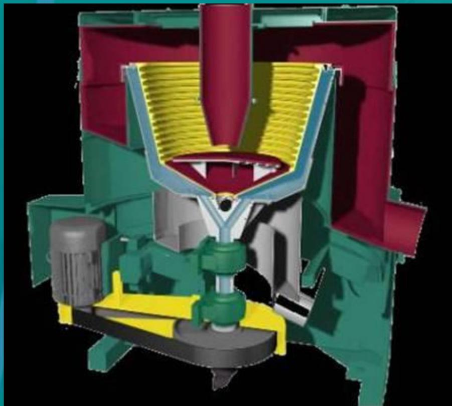
Концентратор CVD с непрерывной разгрузкой
