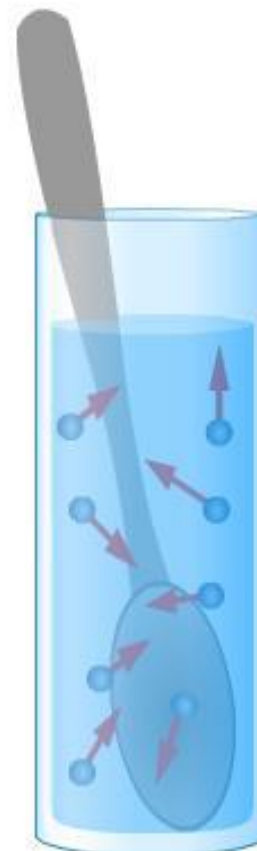
Рисунок 1.7. Передача внутренней энергии от горячей воды к ложке
