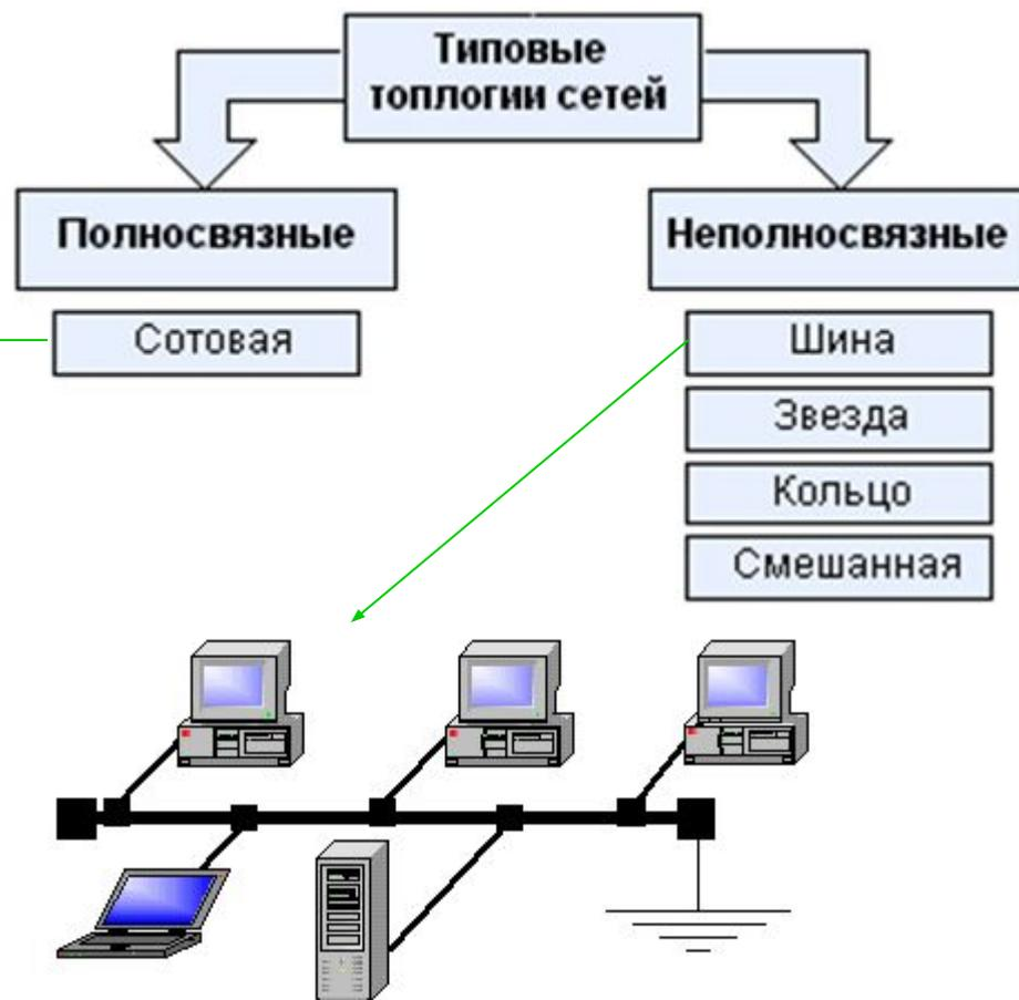
Низкая стоимость. Простота расширения (простота подключения новых узлов и объединения двух подсетей с помощью повторителя).
