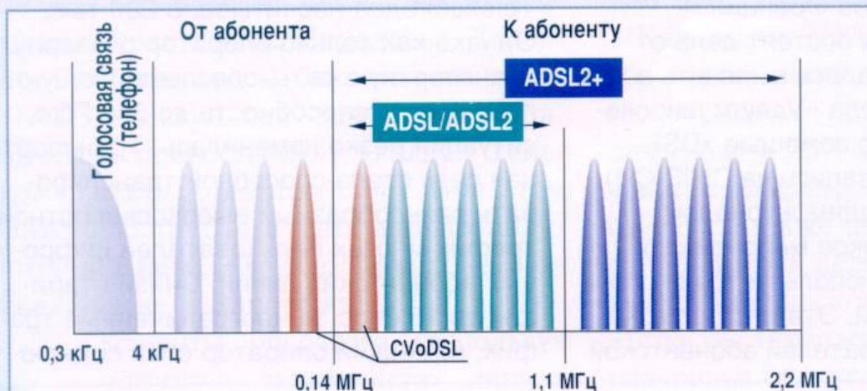
ADSL и ADSL2 для передачи данных задействуют частоты от 4 кГц до 1,1 МГц. Технология же ADSL2+ использует в два раза больший спектр частот
