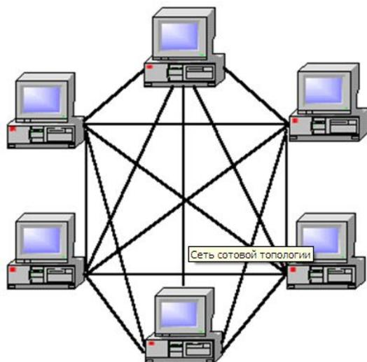
Высокая надежность, обусловленная избыточностью физических связей, простота диагностики.
