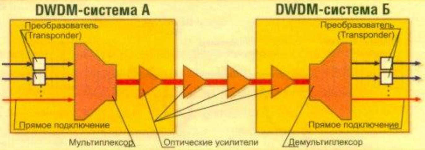
Каждый из сигналов преобразуется в луч с уникальной длиной волны и поступает в мультиплексор, а затем в оптическую среду передачи
