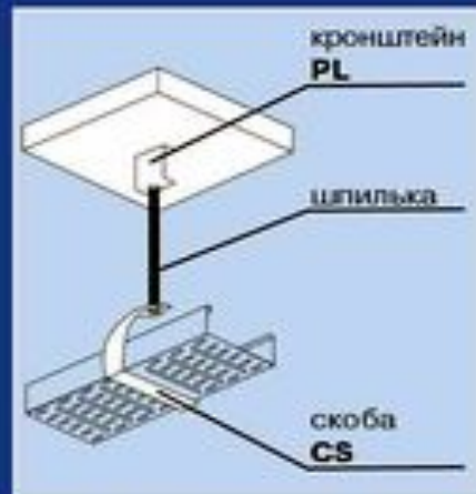
Популярные варианты подвеса лотков при помощи шпилек.
