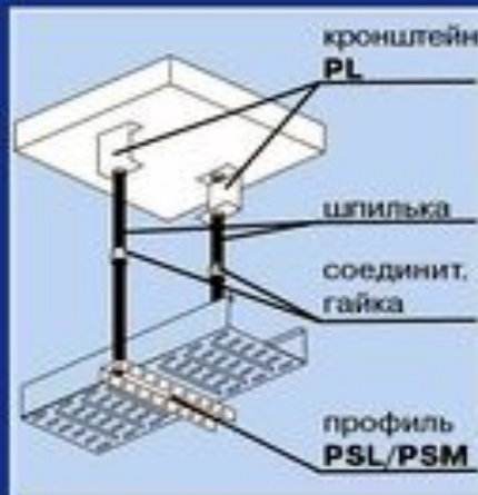
Популярные варианты подвеса лотков при помощи шпилек.
