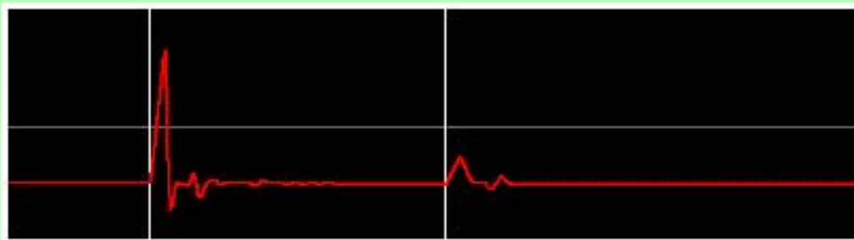
Испытание кабеля импульсом в 2 наносекунды (витая пара)
