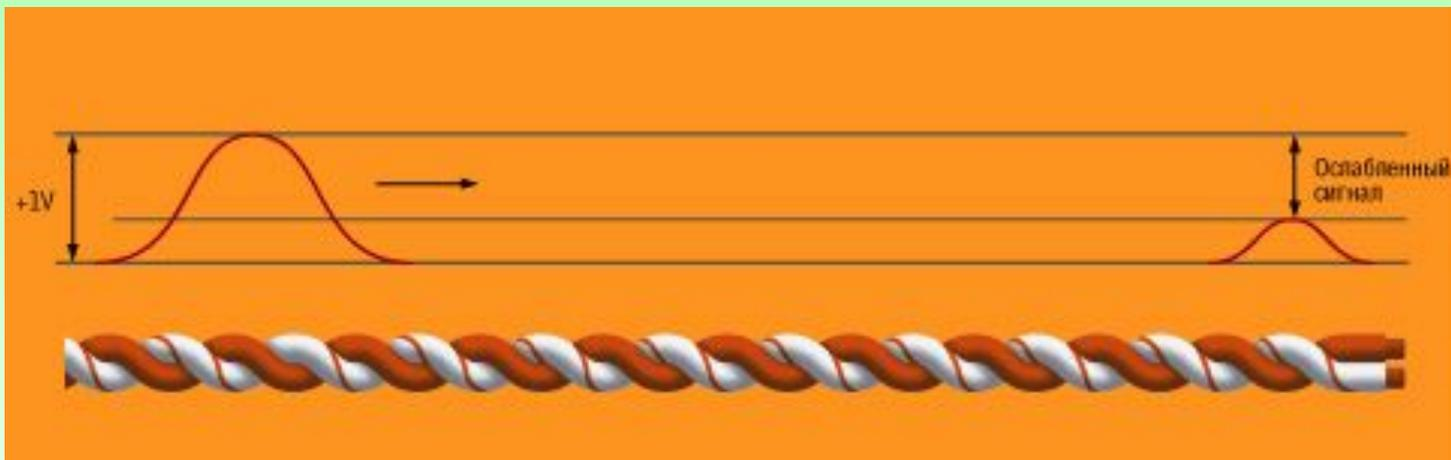
**Погонное затухание** (attenuation) - потеря мощности сигнала, выражаемая в децибелах (дБ, dB):
