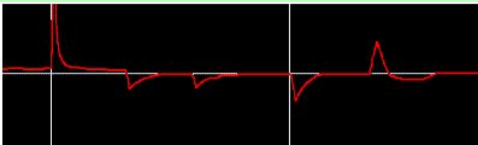
Несколько правильно затерминированных отводов (коаксиал)
