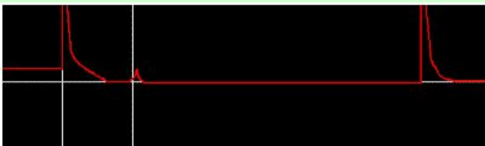
Соединение (муфта) (коаксиал)
