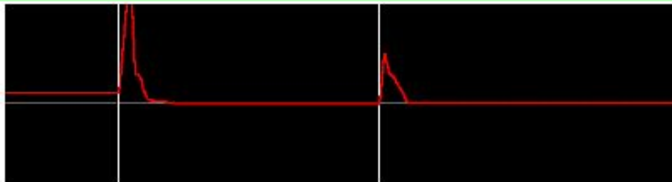
Обрыв кабеля (коаксиал)
