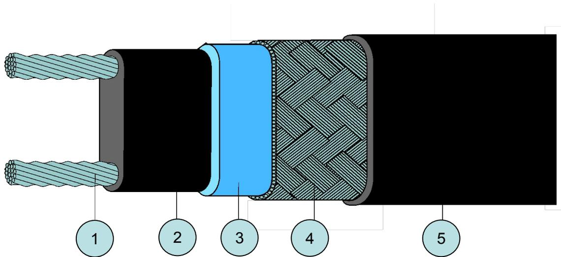
1. Медные провода большого сечения
