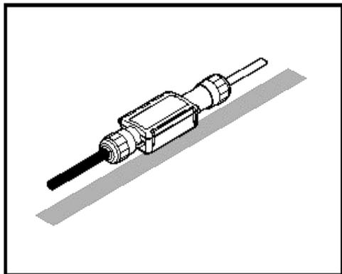
Соединение греющего кабеля с кабелем питания
