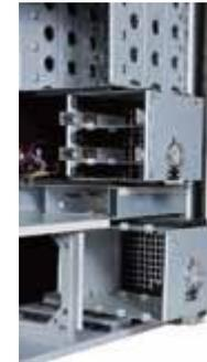
Модульные корзины для HDD. Силиконовые прокладки снижают вибрацию.
