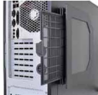
1 боковой 200-мм вентилятор для двух видеокарт. Легкосъемный пылевой фильтр
