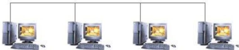
Пример сети с выделенным сервером покажем для соединения по общей шине:
