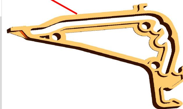
Новый кронштейн крышки привода обеспечивает более жесткое крепление крышки и позволяет фиксировать ее в трех положениях при проведении обслуживания. При длине привода более 4 м рекомендуется устанавливать два комплекта креплений.
