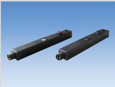
Световой барьер LB 03 (арт. 05102331332) включает в себя передатчик и приемник ИК луча. Рекомендуется устанавливать две пары: на высоте 200 и 1000 мм, но допускается и одна пара: на 800 мм.
