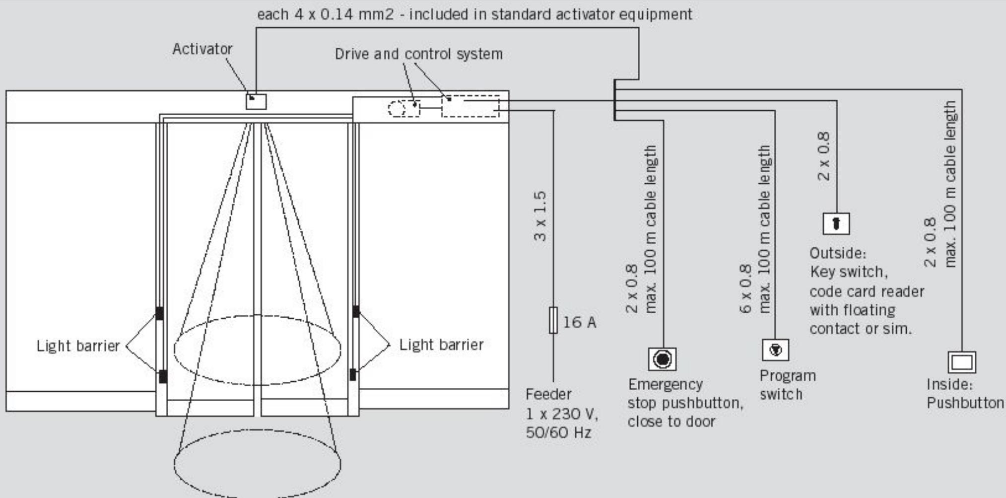
Сечения проводов внешних устройств, подключаемых к приводу.
