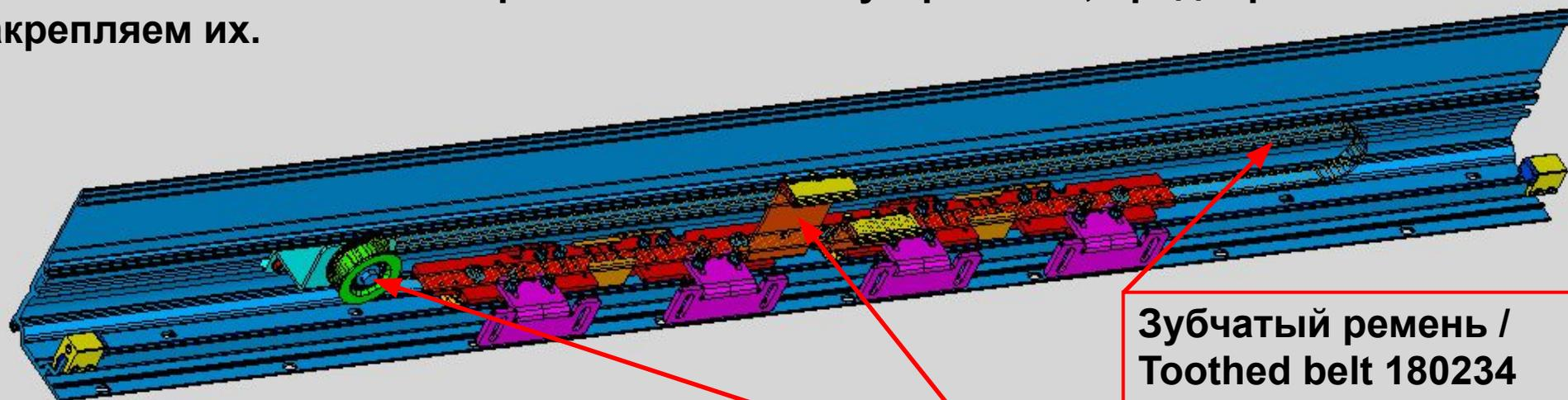
Ролик с натяжным устройством / Pulley with belt tensioner 04010040
