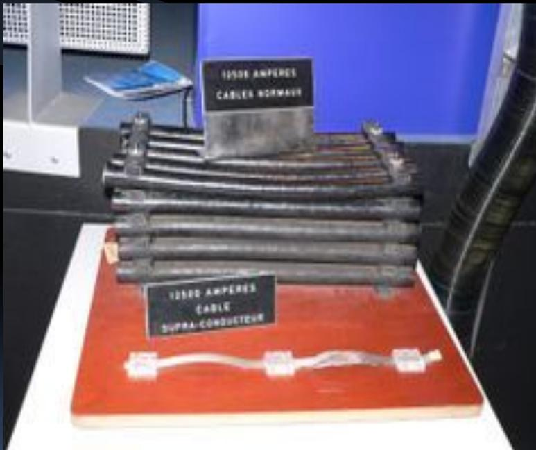
Электрические кабели для ускорителей в CERN: сверху обычные кабели для Большого электрон-позитронного коллайдера; внизу — сверхпроводящие для Большого адронного коллайдера.
