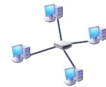
Звезда — базовая топология компьютерной сети, в которой все компьютеры сети присоединены к центральному узлу (обычно сетевой концентратор).
