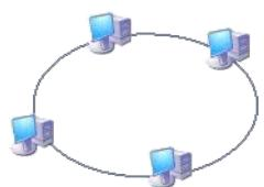
Кольцо — базовая топология компьютерной сети, в которой рабочие станции подключены последовательно друг к другу, образуя замкнутую сеть.
