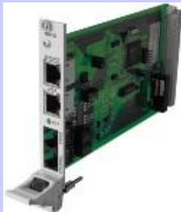
Модем преобразует двоичный код компьютера в аналоговый электрический сигнал телефонной сети при передаче информации (модуляция) и производит обратное преобразование (демодуляция ) во время приёма информации. Основной характеристикой модема является скорость передачи – приёма информации, которая измеряется в битах в секунду –бит/с
