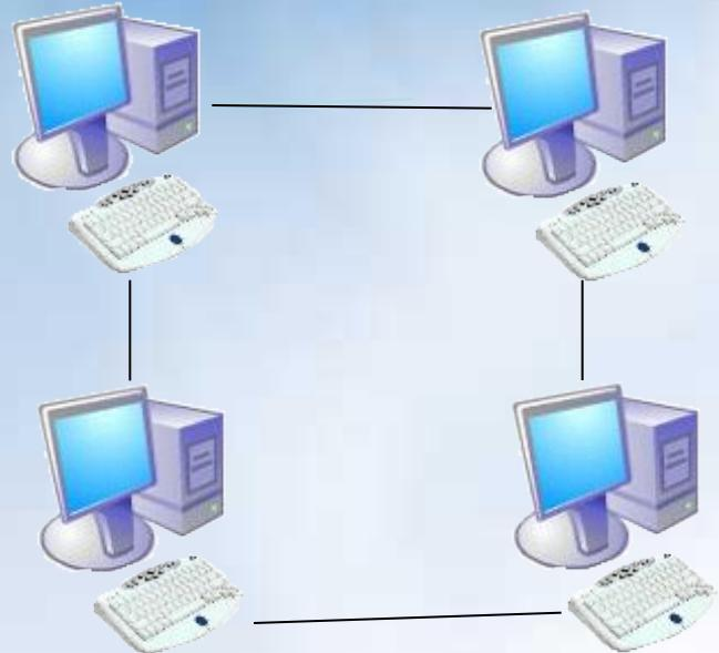
Кабель проходит от одного компьютера к другому, соединяя компьютеры последовательно один за другим
