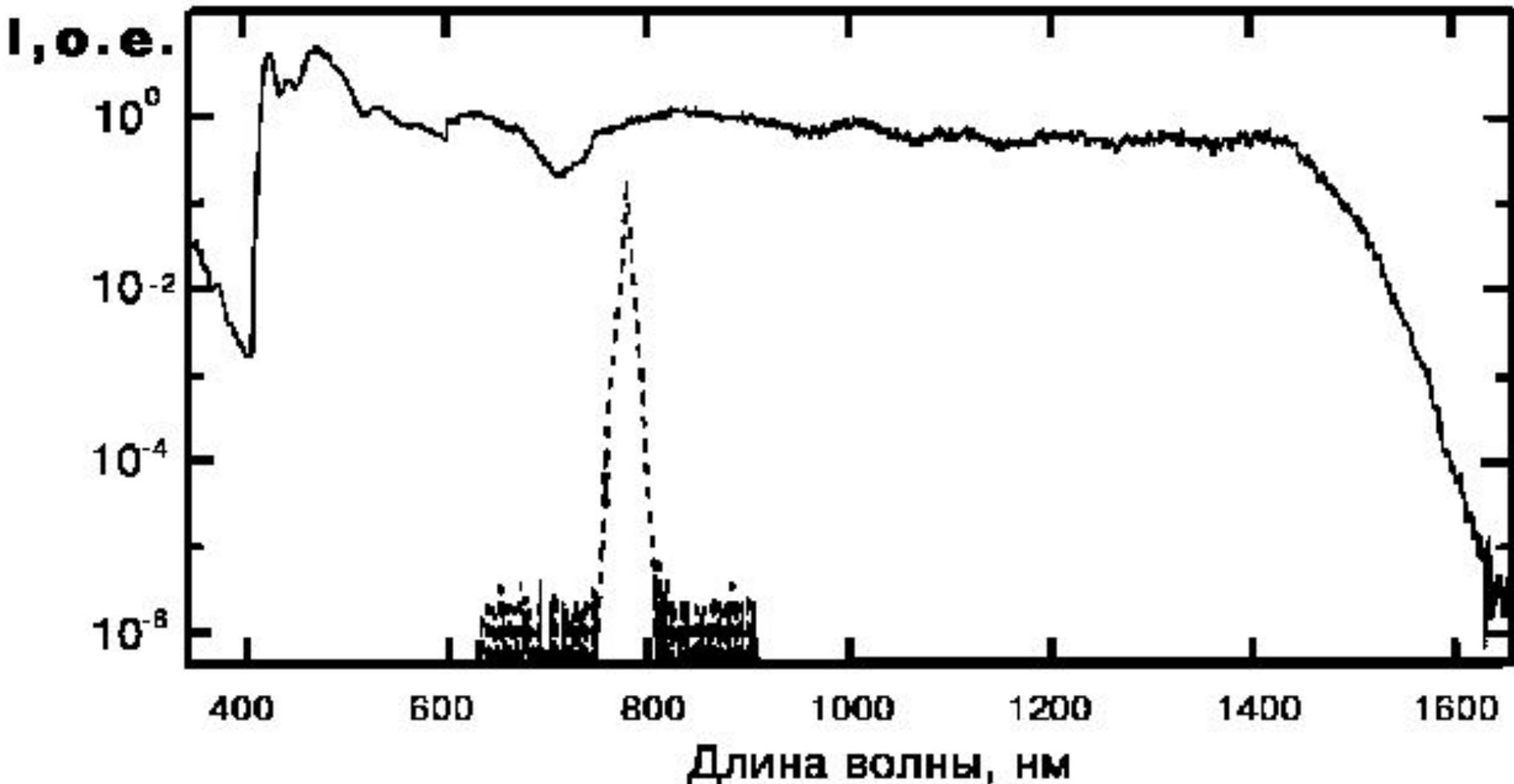
**Широкополосный гиперконтинуум имеет полосу частот по уровню 1% равную 400 ТГц, что позволяет создать 8000 информационных каналов разнесенных на 50 ГГц. При использовании скорости передачи по одному каналу 10 Гб/с, с использованием данного гиперконтинуума возможна передача 80 Тб/с, а при скорости в канале 20 Гб/с – до 160 Тб/с.**
