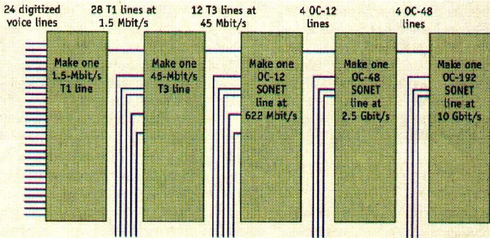
SONET – synchronous optical network – синхронная оптическая сеть в временным уплотнением
