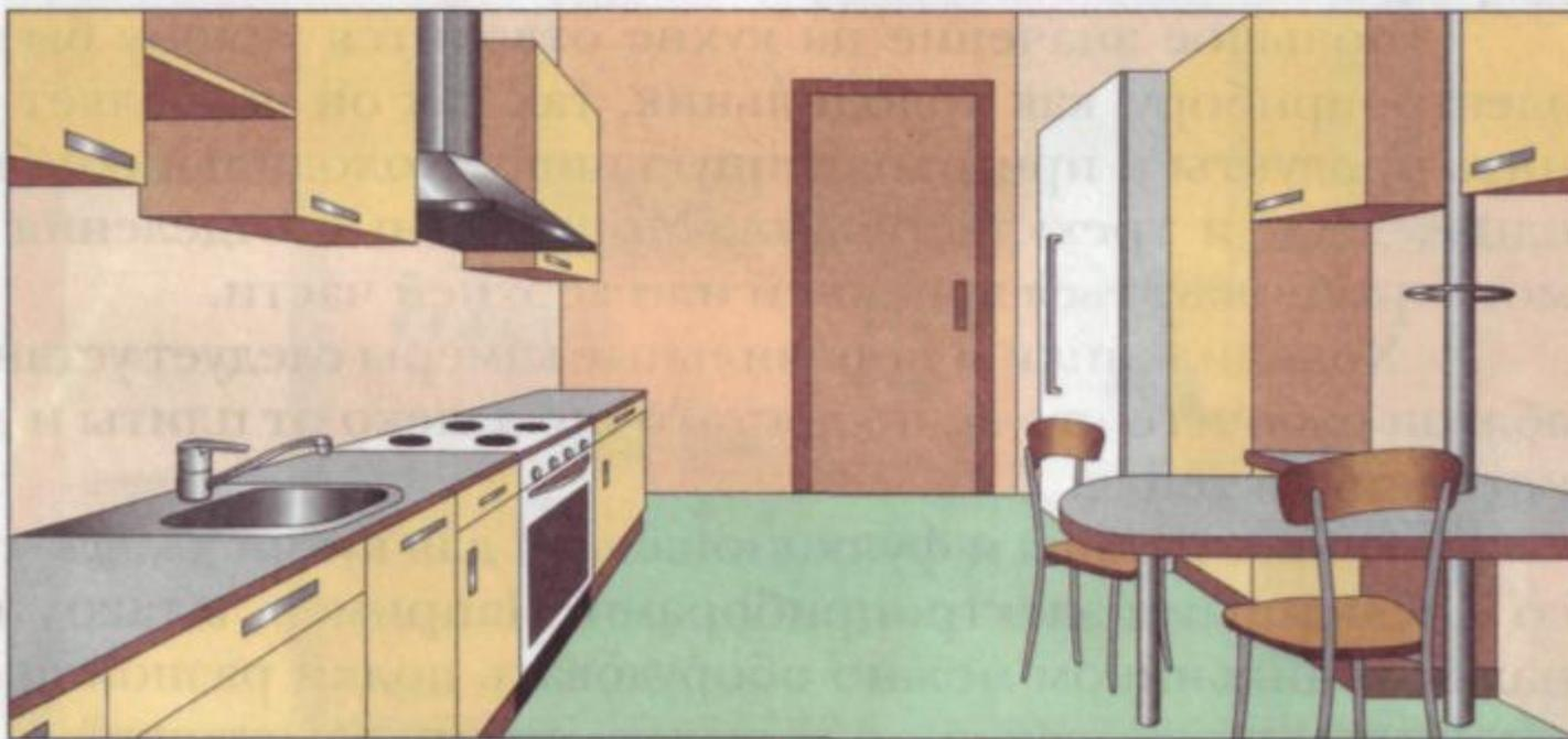
**Рис. 107.** Двухрядное размещение мебели и оборудования на кухне
