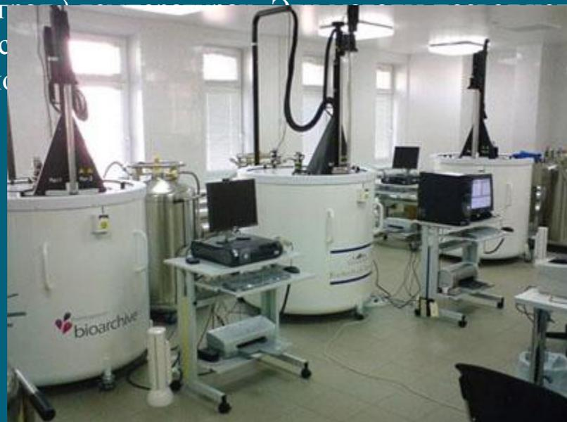
Криохранилище с современными автоматизированными системами для хранения образцов стволовых клеток в жидком азоте
