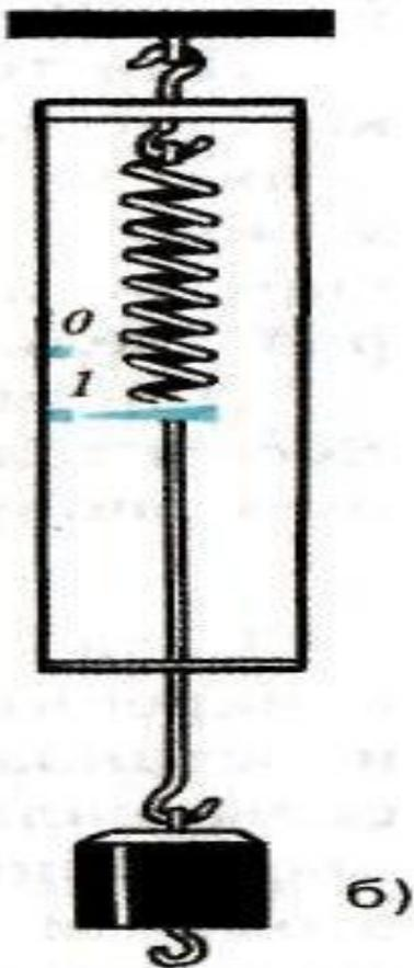
3. Подвесьте к крючку динамометра груз, масса которого 100 г. На этот груз действует сила тяжести, равная 1 Н. Новое положение указателя динамометра также отметьте горизонтальной чертой на бумаге.
