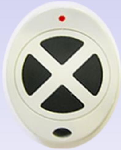
Брелок является основным передатчиком сигнала и имеет двустороннюю связь с приемником, которая позволяет отображать успешность приема сигнала. При нажатии на кнопку, приемнику передается сигнал. В случае успешного приема, на компьютере, к которому подключен приемник, выполняется заранее настроенная последовательность команд.
