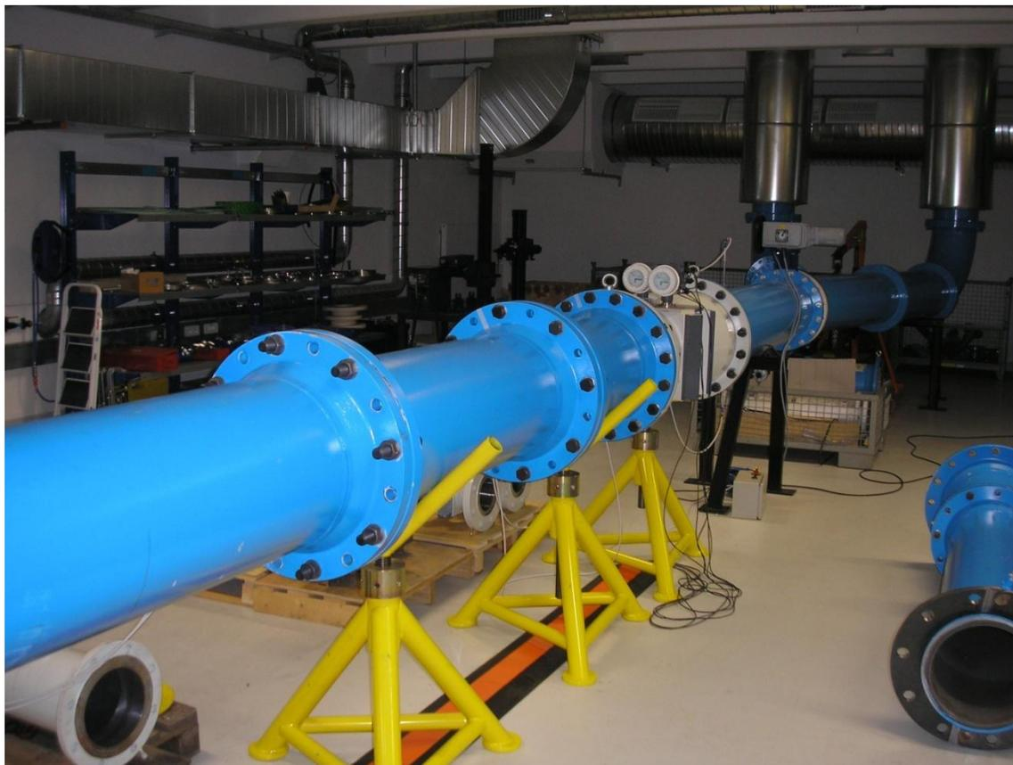
Технология изготовления преобразователей позволяет калибровать приборы на воздухе при атмосферном давлении
