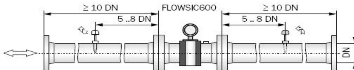
Прямолинейные участки измерительного трубопровода изготавливаются в соответствии с МИ 3213 «Методика выполнения измерений с помощью ультразвуковых преобразователей расхода» и рекомендациями завода-изготовителя ультразвукового счетчика
