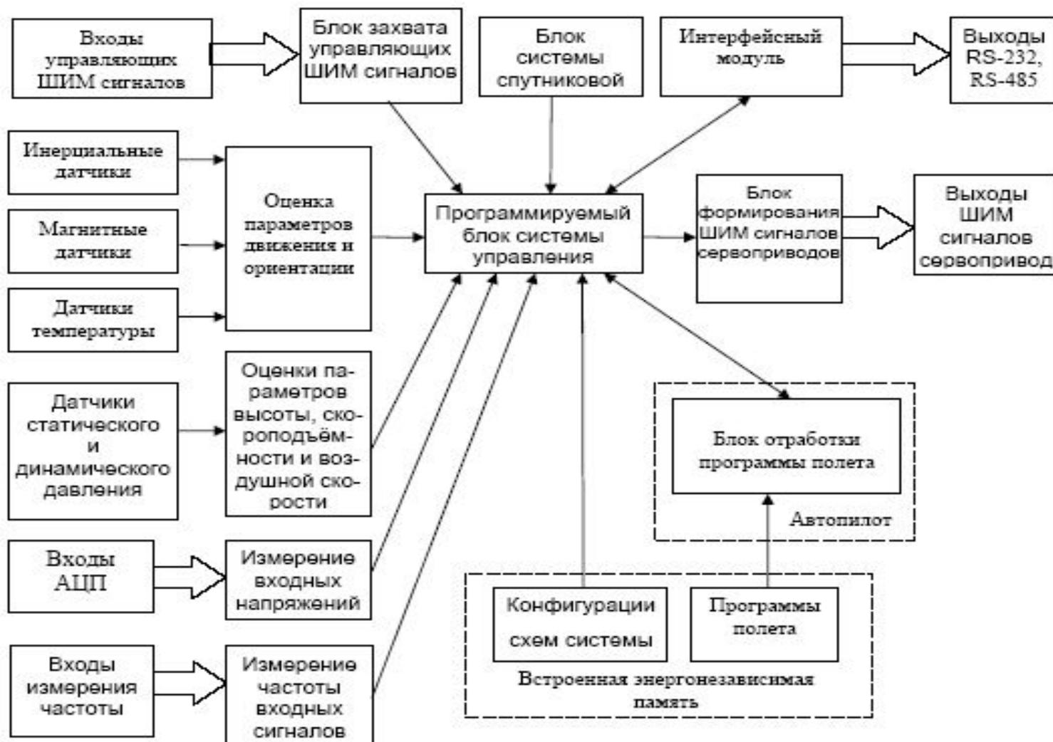
рис. 4. Функциональная схема работы устройства
