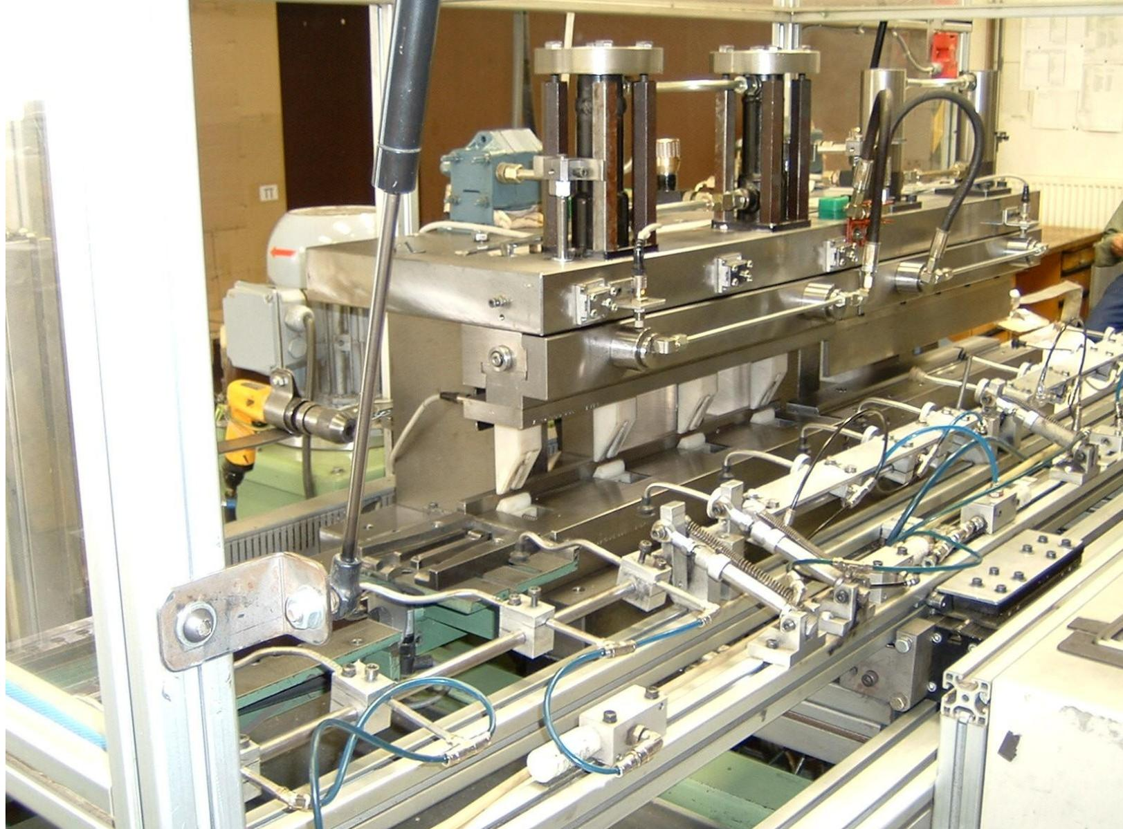
**Корпусные детали светильника изготавливаются на автоматическом комплексе из рулонного материала в автоматическом режиме без участия человека, что гарантирует качество изделий.**
