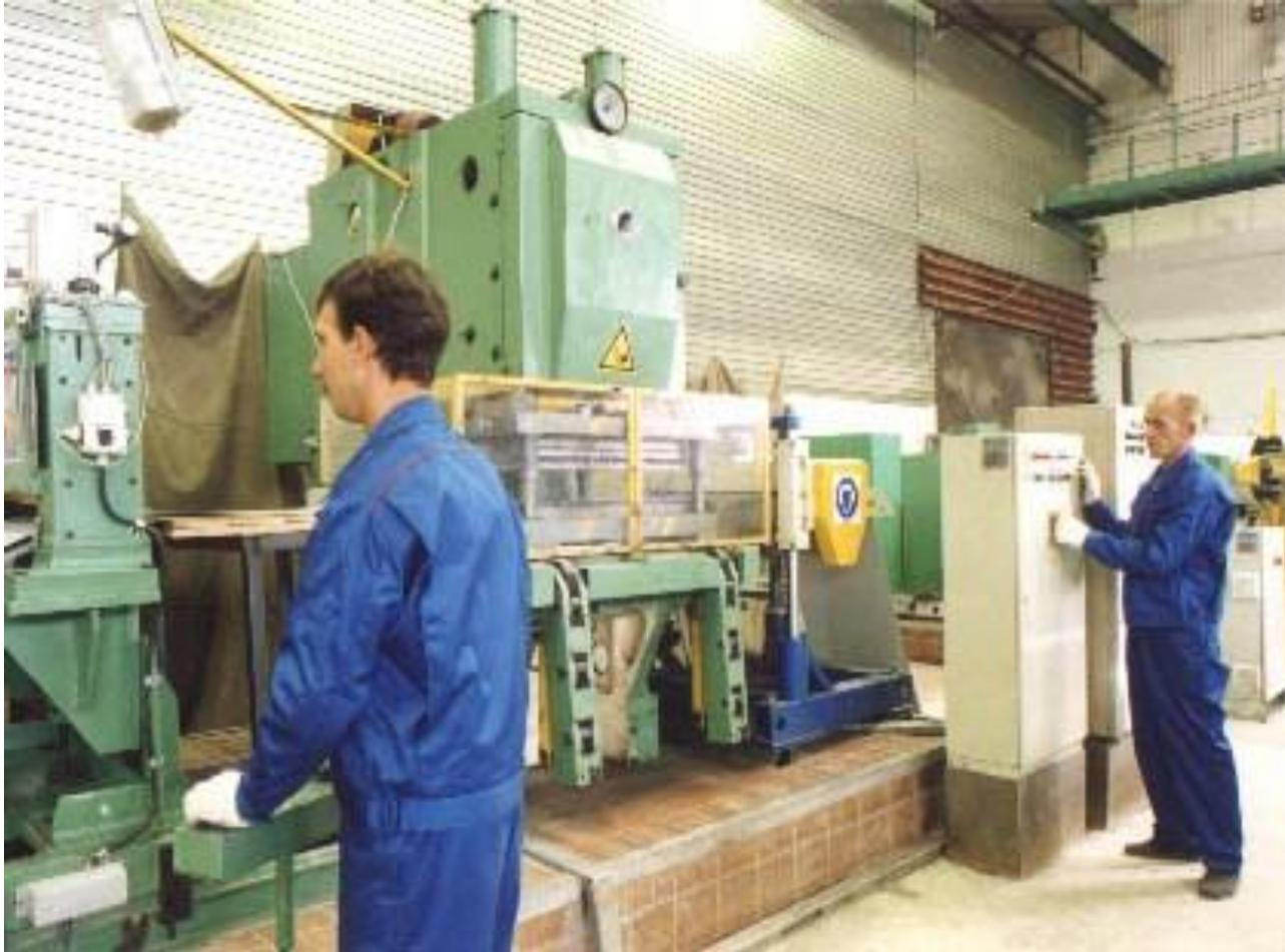
**Бесщелевой цельноштамповый отражатель изготавливается на специализированном автоматическом листоштамповочном комплексе из рулонного материала в автоматическом режиме без участия человека, что также гарантирует качество и обеспечение заранее заданных свойств.**
