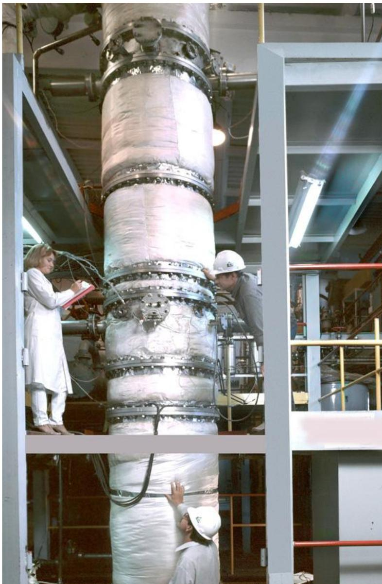
Колонна по разделению фреоновых смесей, на которой реализована методика моделирования процессов разделения жидких газов (H, O, N, Ar), предложенная В.Е. Накоряковым в 1992 году с использованием методов неизотермической абсорбции
