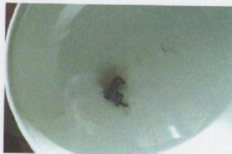
Горит вне огня превращаясь в твердую черную пластическую массу
